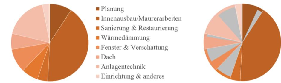
**Bild 5-1** Aufteilung der Gesamtkosten der tatsächlich umgesetzten nZEB-Sanierung (links) und Anteil der energetischen Sanierung (rechts).
